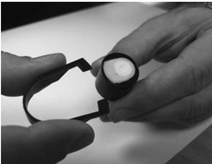
Usando a Ferramenta de Remoção da Pilha de Eletrodos Mini PID fornecida, localize suas 'pontas' nos slots na lateral do Corpo do Sensor Mini PID 2.
